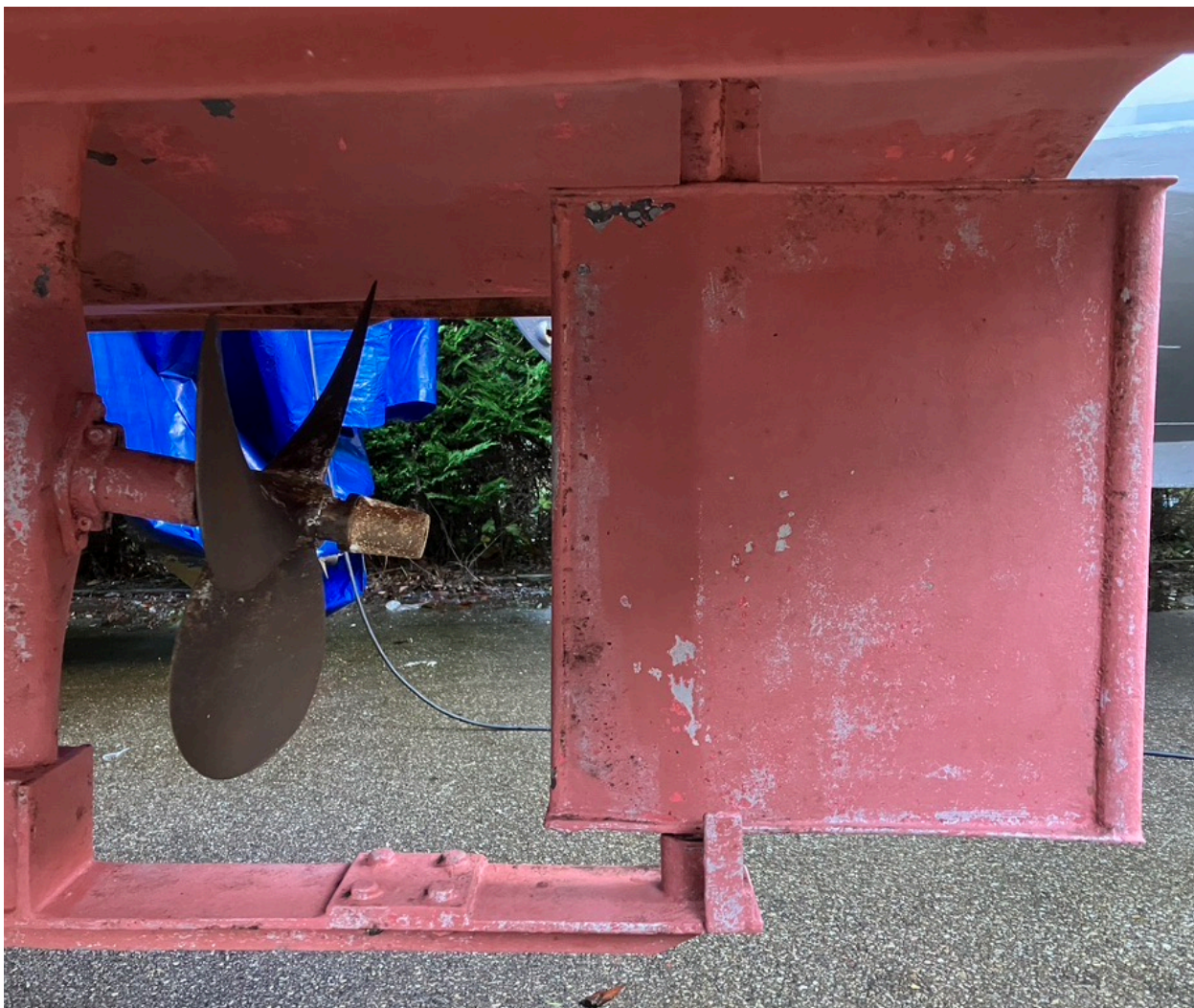
Oud ijzeren plaat-roer. Met stukjes rond gelast aan voor- en achter zijde. Te veel wervelingen langs dit roerblad en daardoor niet koers vast (zwalken).
