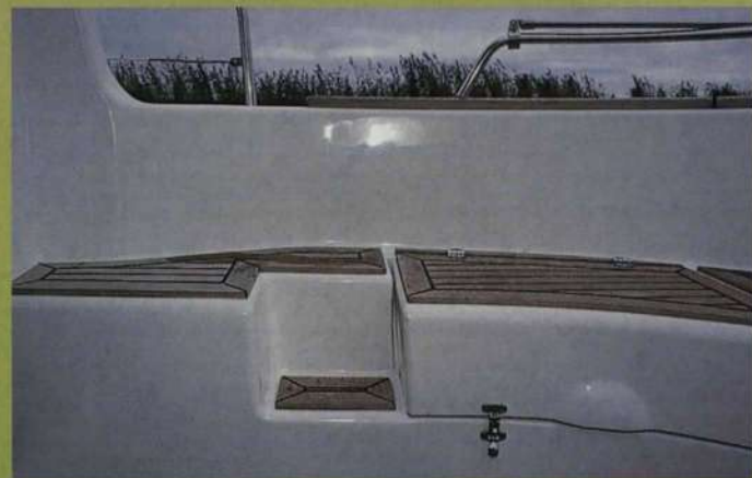
★ Opstap naar het gangboord.
